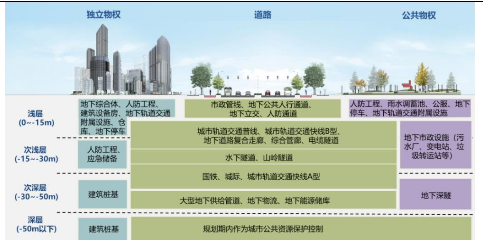
图表 49：浅层地下空间与深层地下空间分布示意图
