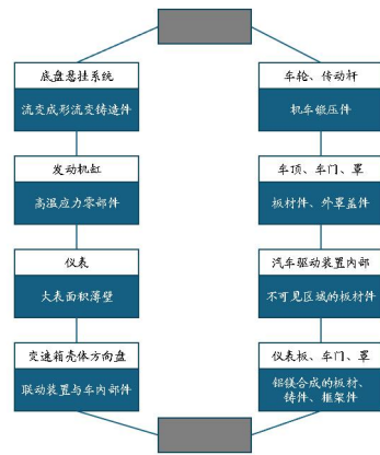
图 23：镁合金在汽车上的应用部位
